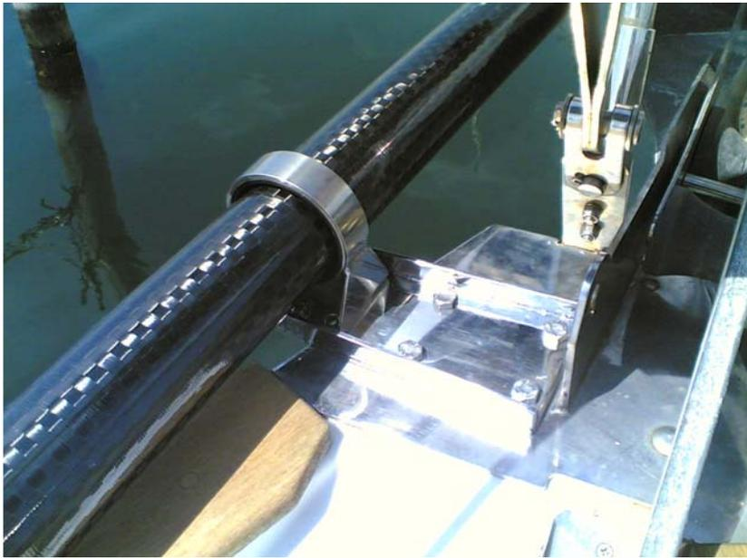
Per questo Bavaria 44', visto il dislocamento importante, abbiamo scelto un bompreso in carbonio da 80mm di diametro esterno e lungo 2500mm. Abbiamo realizzato una staffa speciale, disegnata su misura, per poterci disimpegnare dall'ingombro dell'ancora. Il golfare abbattibile
