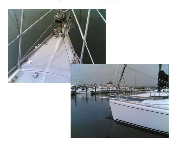
Il "Comet 333" non presenta alcuna difficoltà per l'installazione del nostro bompresso. Abbiamo utilizzato per questa imbarcazione un bompresso di diametro 70mm per 2000mm di lunghezza in alluminio anodizzato(BPM70/20) con la staffa di serie. L'installazione è semplice e la coperta del "Comet 333", una volta riposto il bompresso resta assolutamente pulita.
