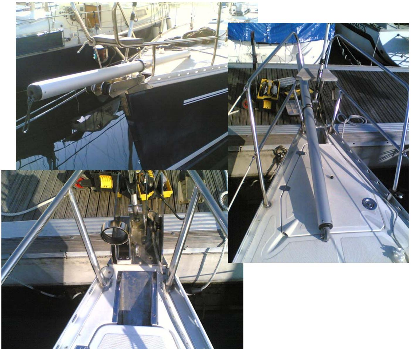
Per installare il nostro bompreso in alluminio anodizzato da 80mm di diametro per 2000mm (BPM80/20) di lunghezza sull' "Elan 40", abbiamo utilizzato una staffa disegnato appositamente. Inoltre, siccome l'imbarcazione arma un Gennaker di ragguardevoli dimensioni, per estrema sicurezza abbiamo applicato in testa al bompreso la prevista ritenuta per il controvento, che va a fissarsi ad un golfare sul diritto di prua.
