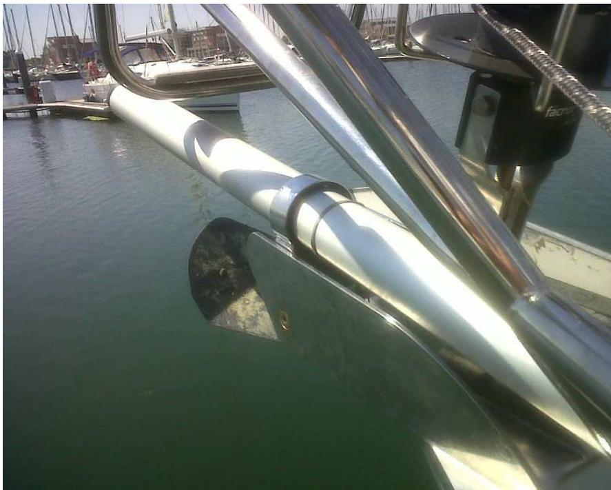
Sull'Oceanis 423 è stato installato un bompreso sfilabile in alluminio anodizzato diametro 70 mm, abbiamo utilizzato una staffa studiata per poter essere montata con facilità all'interno del musone di prua. Il bompreso è stato rinforzato con un altro tubo interno per reggere alle tensioni dovute alla stazza della barca e per contenere il diametro esterno del profilo.
