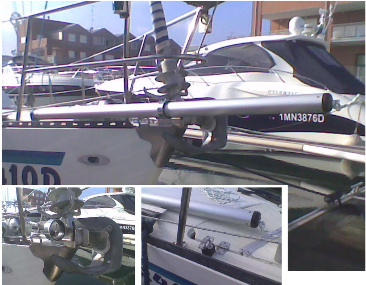
Per il Mousse 905 abbiamo muntato un bompreso sfilabile diametro 70 in alluminio anodizzato con staffa standard montata lateralmente al musone dell'ancora.
