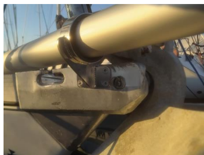
Staffa ad anello imbullonata direttamente sul passa-catena.
