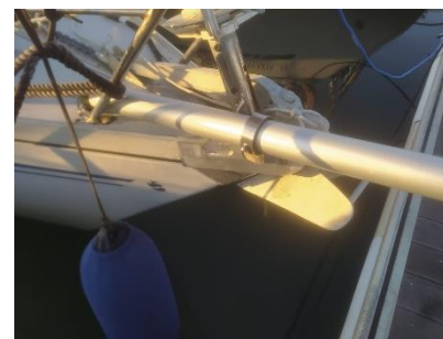
Il bompresso lascia libero il gavone e l'ancora per l'utilizzo in crociera.
