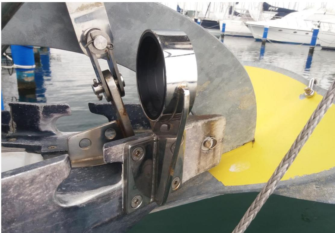
Abbiamo installato il nostro bompresso sfilabile in alluminio diametro 80mm su questo Comet 11 riuscendo a montarlo davanti al gavone dell'ancora in modo da lasciare libera l'apertura.
