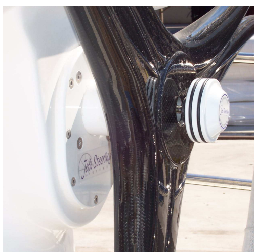
Dettaglio della scatola di governo BG12QM installata sulla colonnina realizzata dal cantiere
