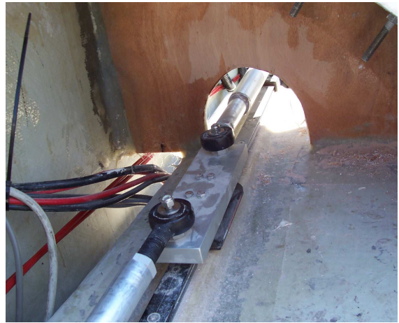
L'asta che collega i due timoni è divisa in 3 parti tenute in guida da carrelli su sfere
