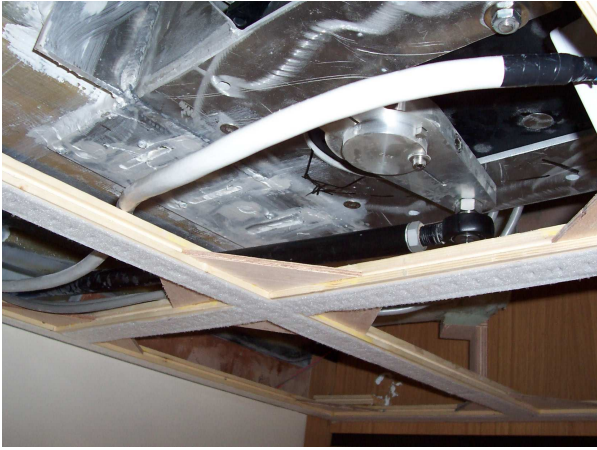
Una delle due scatole di riduzione RG10-50 montata sotto alla relativa colonnina
