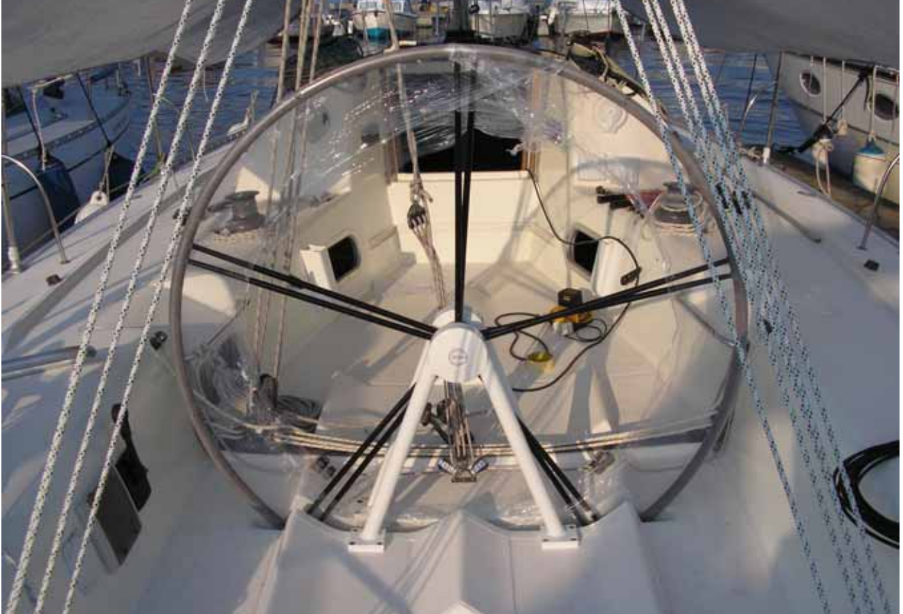
Colonnina a forma di doppia A come sulla X-35 e ruota in alluminio da 1400 mm
