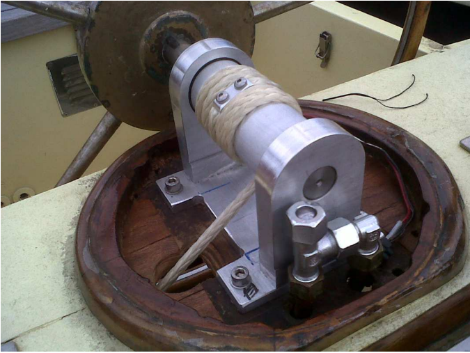
Nuovo sistema di supporto ruota timone JEFA con tamburo per frenelli in VECTRAN. I tubi del sistema idraulico è stato chiuso per poter utilizzare I cilindro con l'autopilota.
