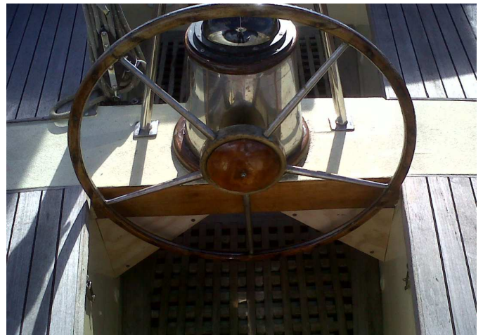
Ruota timone e chiesuola porta bussola originale che nasconde il tamburo del sistema a frenelli.
