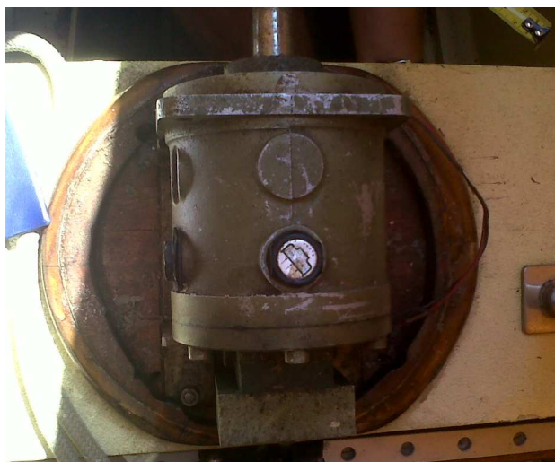
Sistema originale del supporto ruota timone collegato alla pompa dell'olio per il cilindro idraulico.
